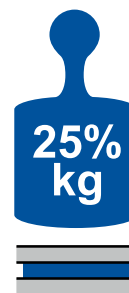
Montaggio orizzontale = 25% della portata citata
